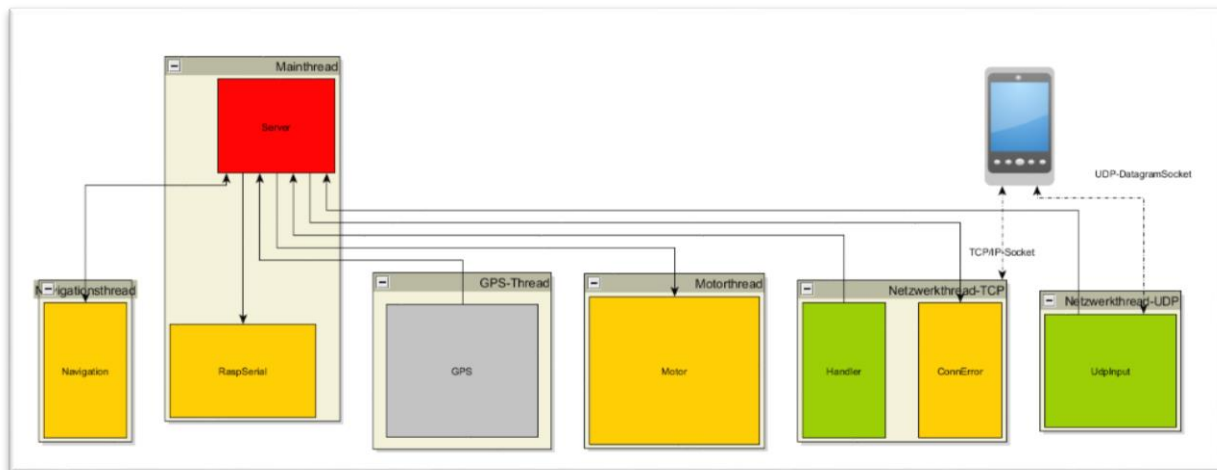
Abbildung 11: Schematische Darstellung der Programmstruktur des SmartBot-Servers
